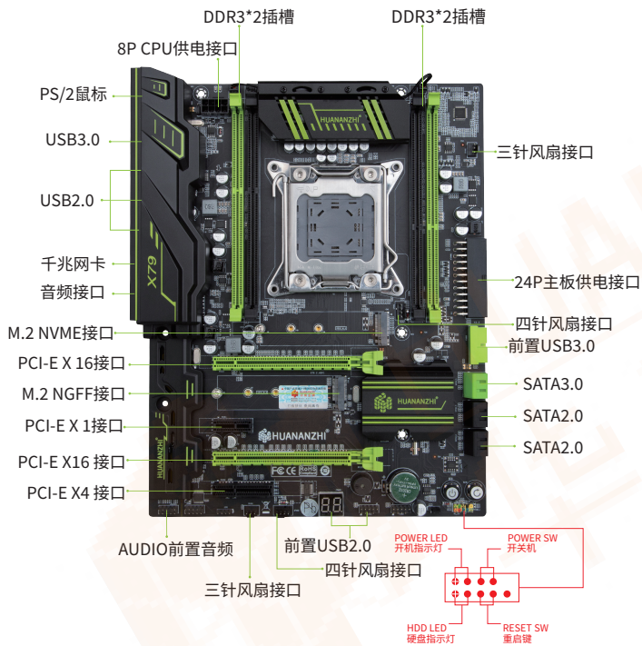
图1-1 X79 豪华V2.1主板图解
